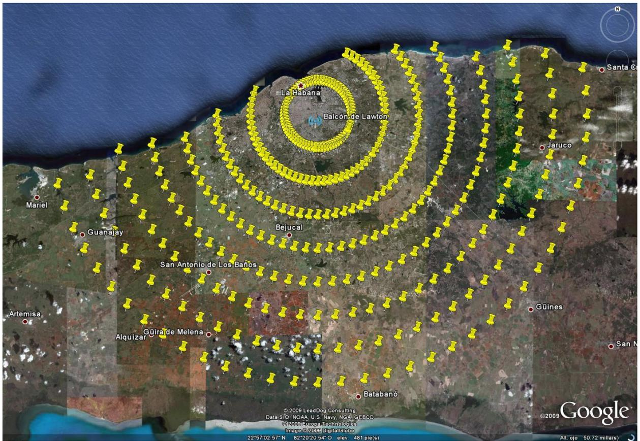
**Fig. 5: Puntos de medida de cobertura distribuidos alrededor de la antena transmisora Balcón de Lawton**
