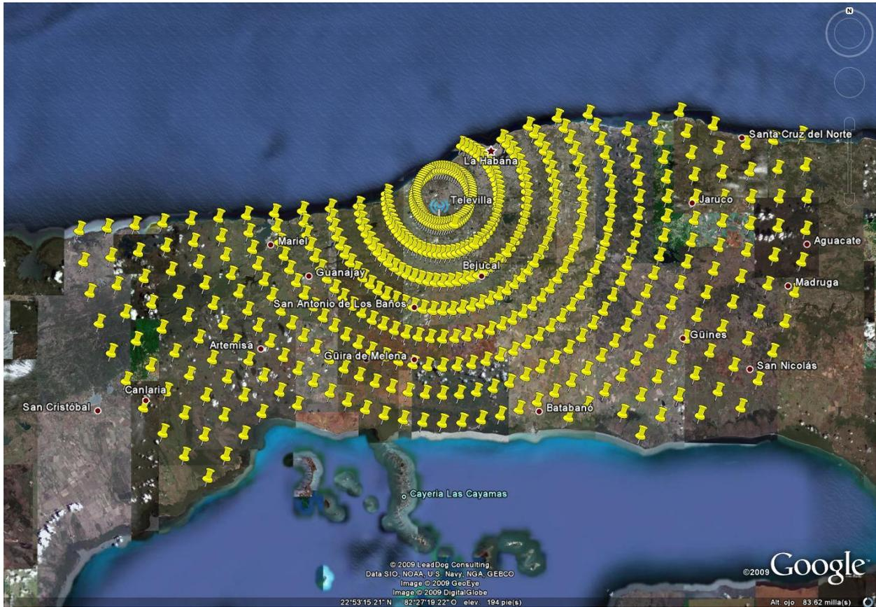
**Fig. 3: Puntos de medida de cobertura distribuidos alrededor de la antena transmisora Televilla**
