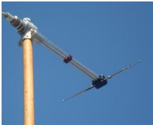
**Fig. 2: Dipolo ajustable empleado en las mediciones**
