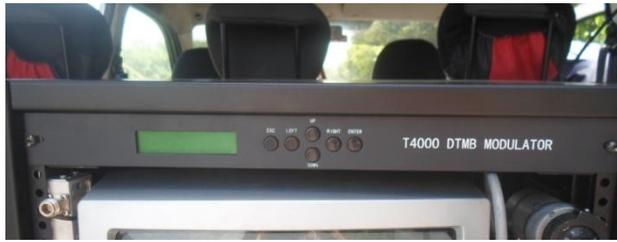
**Fig. 10: Modulador DTMB empleado en las mediciones para generar ruido**
