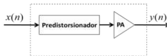
Figura 3: Sistema simulado en MatLab.
