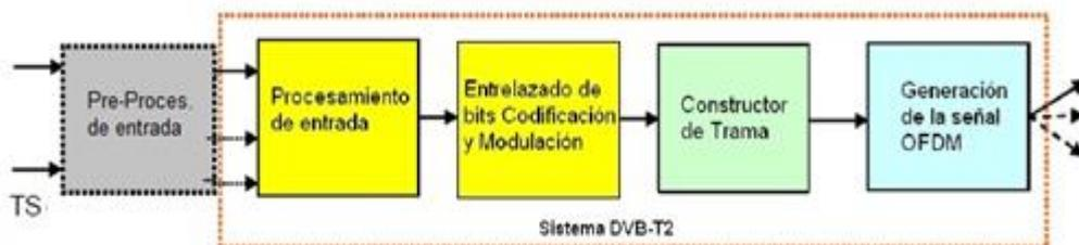
Figura 4. 1 Estructura general del sistema DVB-T2.
