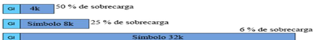
Figura 7: Reducción de la sobrecarga del intervalo de guarda con un mayor tamaño de FFT.
