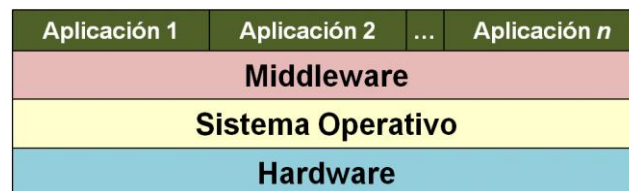
Figura 3. Capas de un decodificador para sistemas TDA.
