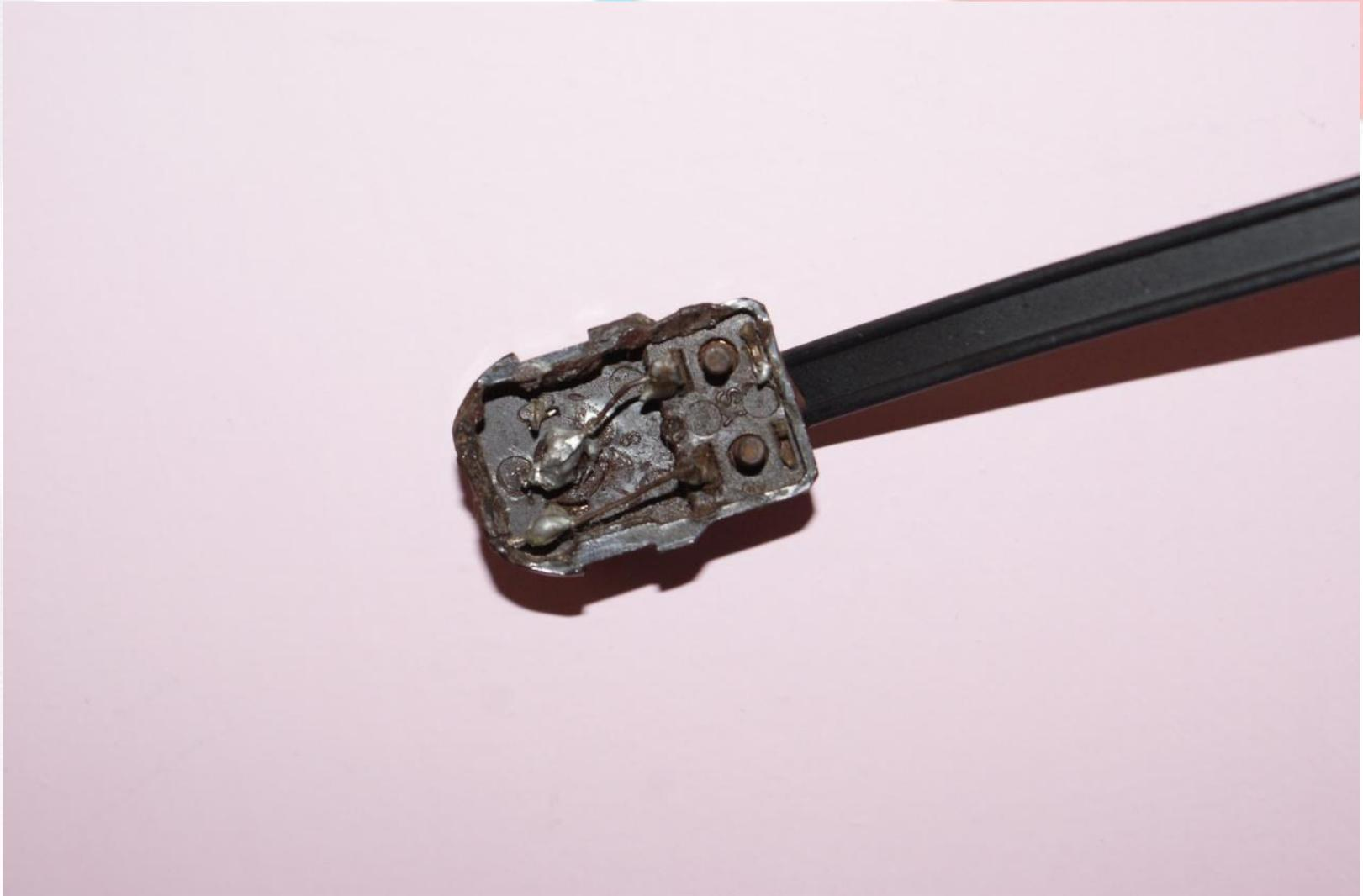
**Adaptador de impedancias (cachimba) con bobinas eliminadas (puenteadas).**
